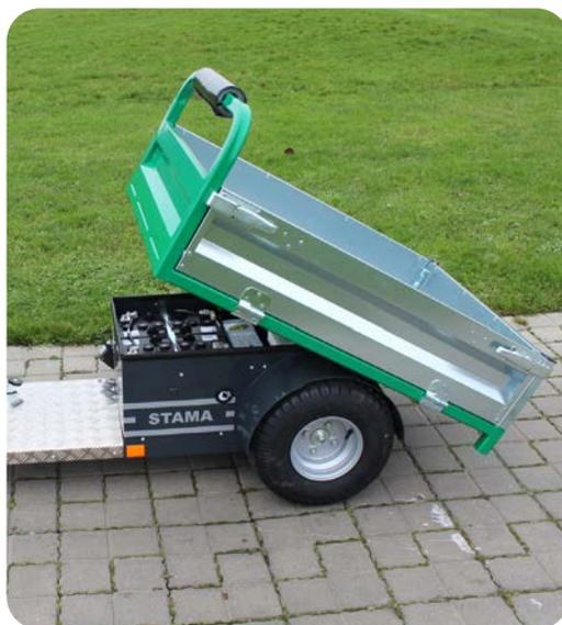
Kipper zum Entladen und Zugang zur Batterie
