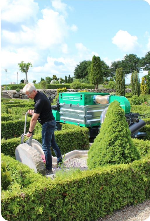
6 m flexibler Saugschlauch mit ergonomisch geformten Handgriff
