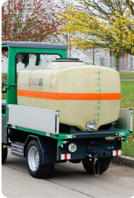
Mit aufgebauter Giessanlage und elektrischer Unterflurpumpe
