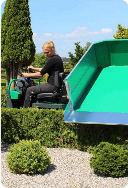
Hydraulische Kipppritsche und 180° schwenkbar
