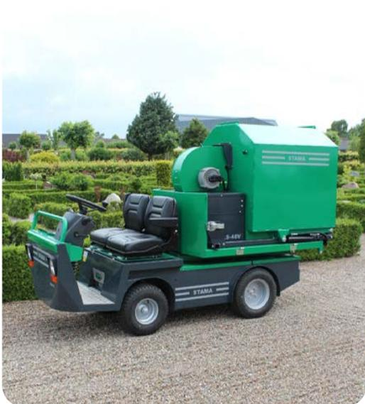
Ausführung mit vollelektrischer Saugereinheit
